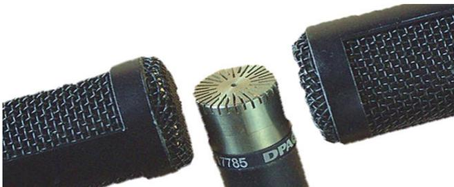
**Abb. 6:** Das koinzidente Mikrofonarray aus einer Kugel (DPA 4006) und zwei Achten (MKH30) zeigt, dass es in der Praxis unmöglich ist, alle Mikrofonkapseln genau an derselben Stelle zu platzieren.
