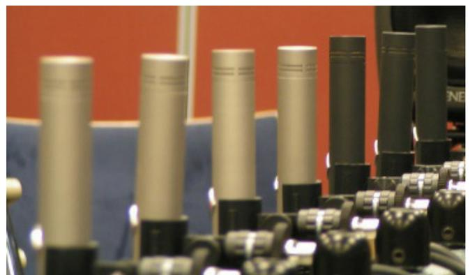
**Abb. 1:** Räumliches, lineares Mikrofonarray, bei dem die Mikrofone in einer Reihe angeordnet sind.
